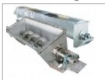
Винтовые конвейеры предназначены для транспортирования на небольшие расстояния (до 30..40 метров) сыпучих, мелкокусковых, вязких и тестообразных материалов, например цемента, извести, молотой и мокрой глины, бетона, биологических отходов и т. д. Преимущество винтового конвейера относительно других видов конвейеров заключается в простоте
